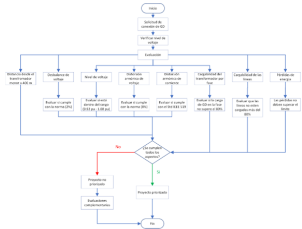
Figura 15: Metodología de Selección de GD Trifásica Conectada a la Red de Baja Tensión [2]
