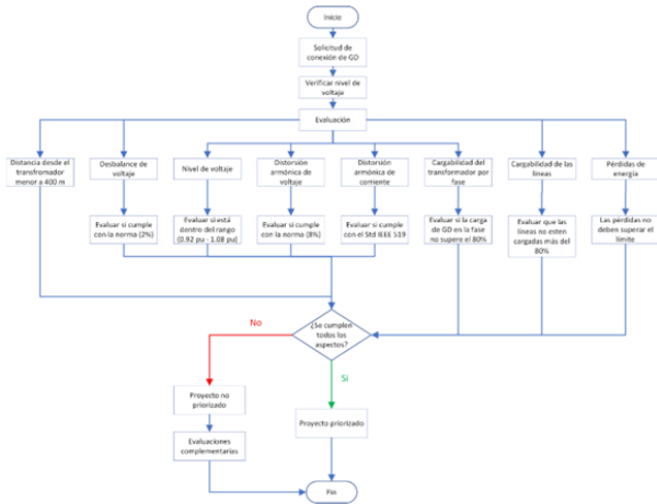
Figura 14: Metodología de Selección de GD Monofásica en la Red de baja Tensión.[2]
