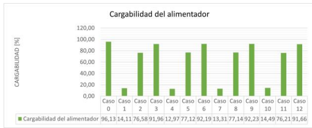
Figura 13: Cargabilidad de las Líneas de Distribución en la Red de Media Tensión[2]
