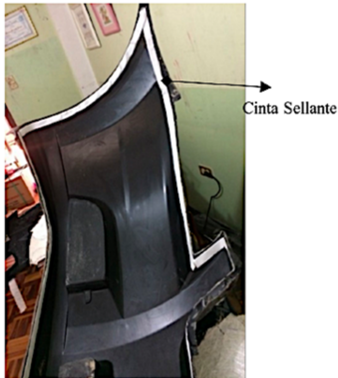
Figura 11. Colocación de la cinta sellante sobre el molde
