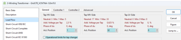
Figura 13: Verificación del tap del TR_VCNTNA-1
