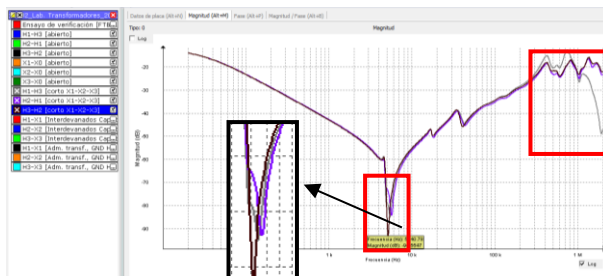
Figuras 6: Curvas Magnitud vs Frecuencia de SFRA, Configuración Ycc para H1, H2 y H3 – Comportamientos Atípicos de las Trazas
