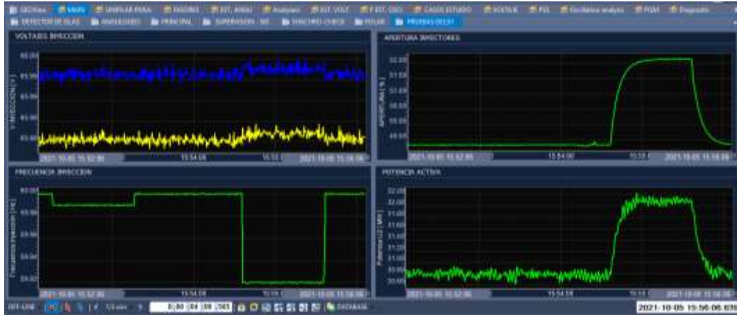
Figura 11: Pruebas de verificación de actuación de Banda Muerta
