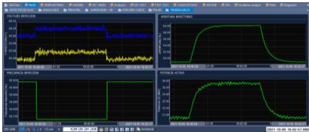
Figura 9: Pruebas al regulador de velocidad - Decremento de frecuencia
