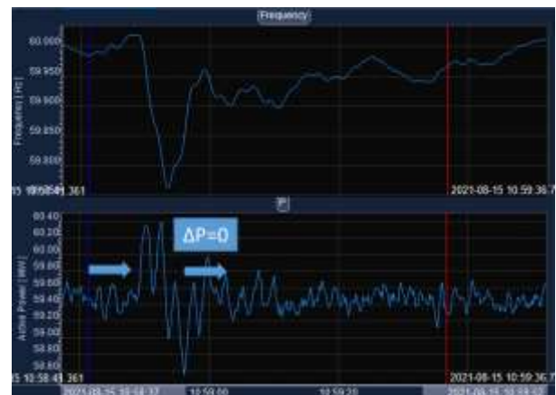
Figura 5: Respuesta de Frecuencia de una unidad de la Central Delsitanisagua previo a la intervención del regulador de velocidad
