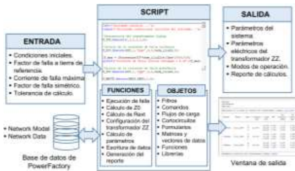
Figura 8: Diagrama general del script en DPL para calcular los parámetros eléctricos del transformador Zig-Zag
