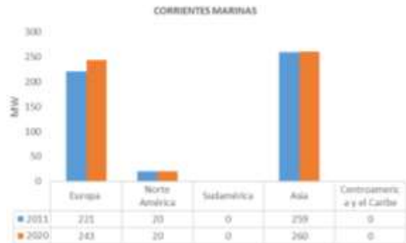
Figura 6. Capacidad instalada en generación basada en corrientes marinas
