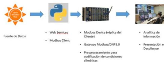
Figura 1: Arquitectura del sistema de condiciones climáticas
