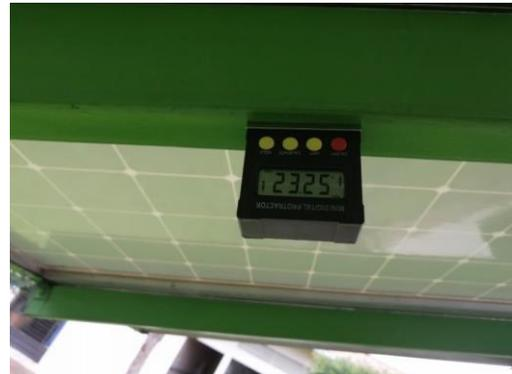
Figura 3: Ángulo de inclinación de los paneles fotovoltaicos ubicados U.P.S.
