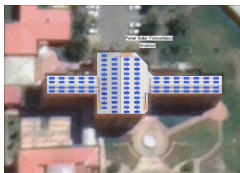
Figura 7. Distribución de los paneles edificio central
