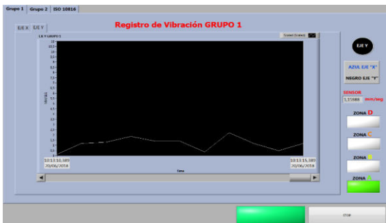
Figura 10: Registro de vibración instantáneo, eje radial (R)
