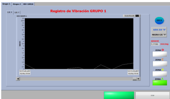
Figura 9: Registro de vibración instantáneo, eje axial (A)
