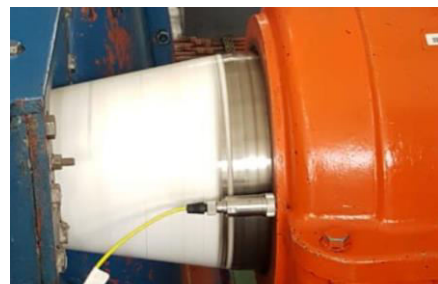
Figura 6: Ubicación del sensor en el eje axial (A)
