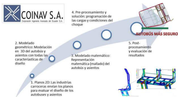
Figura 2. Metodología práctica de ensayo estructural de autobuses
