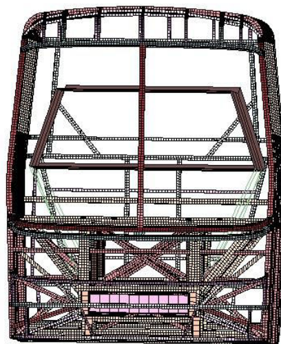
Figura 4. Modelo matemático correspondiente a la estructura completa.
