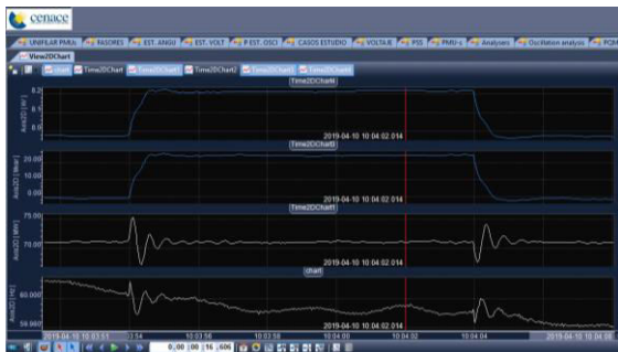
Figura 19: Evento registrado por el WAMS del CENACE para la identificación de los modelos de las unidades de la Central Paute – Molino.
