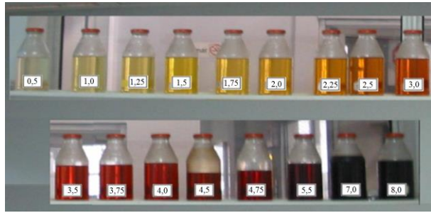
Figura 6: Colores y examen visual del aceite usado ASTM D1524 [40]
