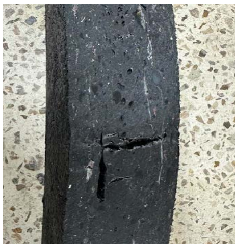
Figura 5. Resultados del ensayo de flexión del Experimento 1.
