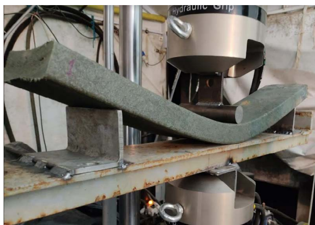
Figura 7. Resultados del ensayo de flexión del Experimento 2.
