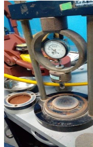
Figura 4. Prueba de expansión del suelo de Metetí, Darién
