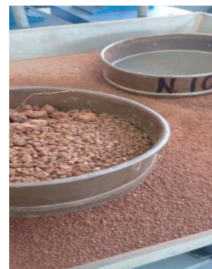
Figura 2. Tamizado de la fracción gruesa del suelo con el Tamiz N°10
