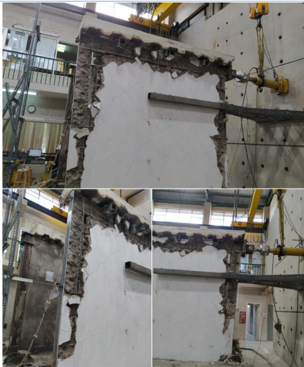
Figura 8. Curva de histéresis y niveles de daño para el pódico con panel rehabilitado
