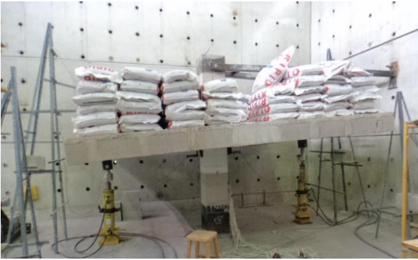
Figura 3. Losa con carga vertical y gatos hidráulicos colocados en la dirección de análisis.
