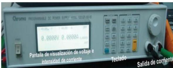
Figura 1. Equipo de simulación DC Power Supplied Chroma
