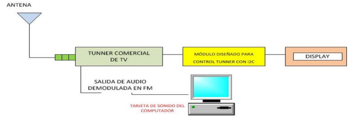
Figura 3. Diagrama en bloques del Receptor de señales satelitales.
