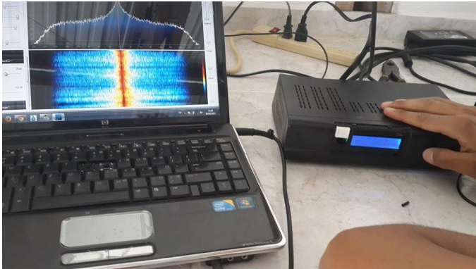
Figura 4. Receptor Satelital de señales conectado a la tarjeta de audio del computador.
