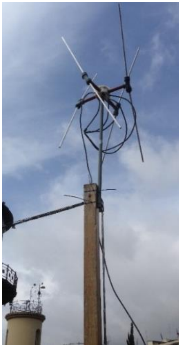
Figura 2. Fotografía de antena doble cross OAQ.
