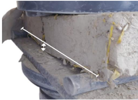
Figura 12: Deformación a flexión de 25mm en los adobes estabilizados con paja de cebada.
