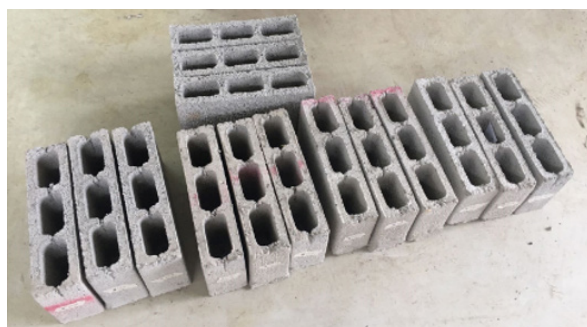
Figura 1. Probetas para ensayos de compresión y flexión
