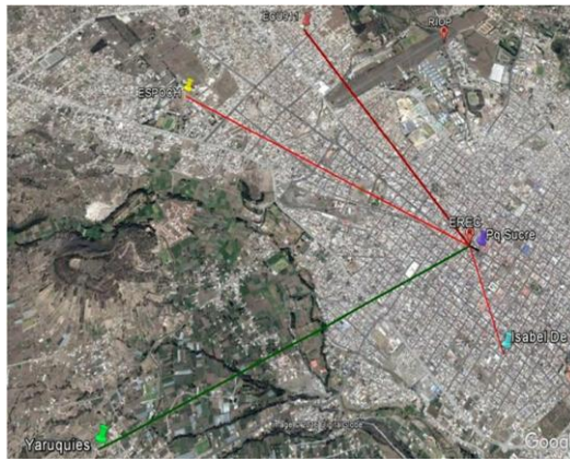
Fig. 9: Sectores urbanos de la ciudad Riobamba: Se considera cuatro sectores a distancias deferentes respecto a la estación de referencia.
