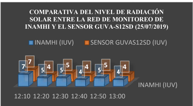
Fig. 16. Gráfica del IUV obtenido, entre INAMHI y el sensor GUVa-S12SD, en función de las 12 horas del día (clima: semi-soleado y nublado).
