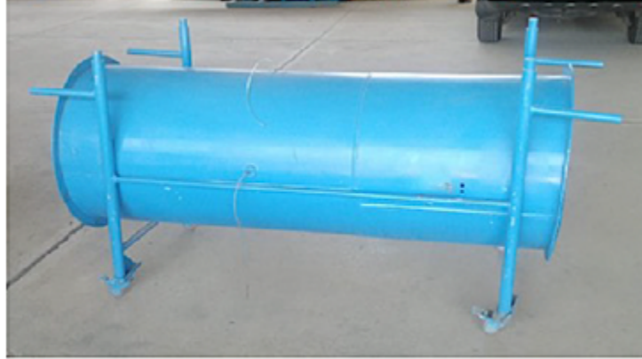
Figura 13. Ducto de ventilación para las pruebas.
