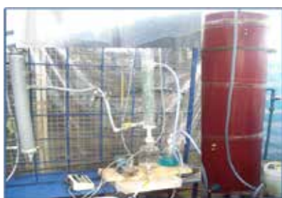
Figura 10. Sistema de prueba de biofiltración con tres lechos, para la remoción de sulfuro de hidrogeno
