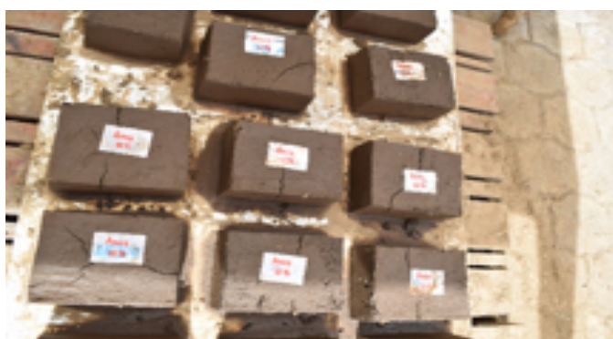
Figura 8.- Adobes con cáscara de arroz, donde se evidencia las fisuras en su superficie, fuente: Ing. Freddy Paredes Avilés.
