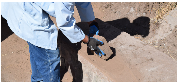
Foto 9.- Preparación de los adobes para ser sometidos a la compresión, fuente: Ing. Freddy Paredes Avilés.
