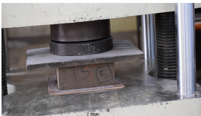
Foto 10.- Adobes sometidos a la compresión, fuente: Ing. Freddy Paredes Avilés.
