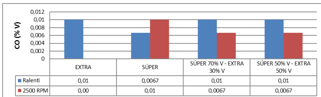
Figura 13. Comparación de valores de CO a ralentí y a 2500 rpm
